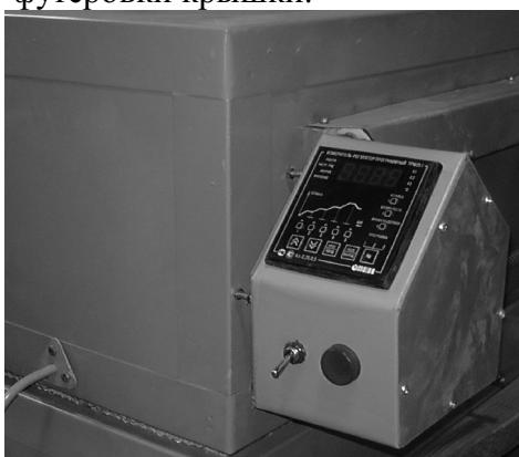
Печь подключается с помощью вилки к сети переменного тока 220 В 50 Гц.
