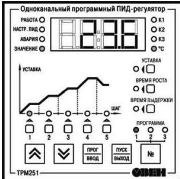
После загорания светодиода РАБОТА кнопку ПУСК/ВЫХОД можно отпустить. Через несколько секунд должен раздаться щелчок сработавшего реле и загореться светодиод K1, что свидетельствует о начале рабочего процесса. Мы рекомендуем не отходить от печи до момента начала роста температуры в рабочей камере, чтобы убедится в начале исполнения программы.
